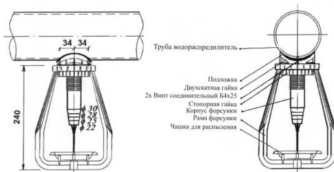
Рисунок 6. Форсунка РТ 240.
